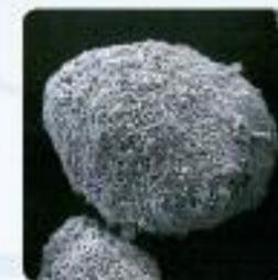
Granules de phosphate de calcium biphase microporeux (50% d'hydroxyapatite et 40% de phosphate tricalcique β) en suspension dans un véhicule hydrogel (HPMC). Formule brevetée.
